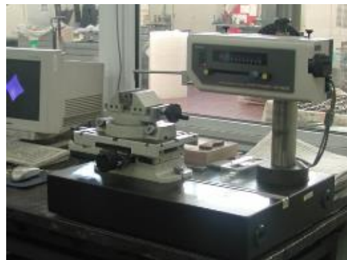
Figura 9: Particolare della macchina di misura tridimensionale COORD 3 - Profilometro
